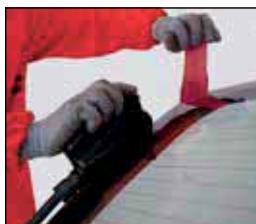
**IT** Rapida rimozione di vetri su parti da verniciare. • Efficace rimozione di vetri anche con maggiore quantità di sigillante (es. Furgoni). • Permette il riutilizzo di vetri con garnizione incorporata.
